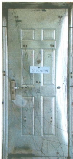
照片 2 耐火试验结束时试件情况
