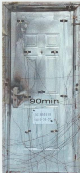
照片 2 耐火试验结束时试件情况
