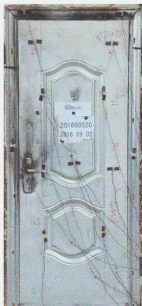
照片 2 耐火试验结束时试件情况
